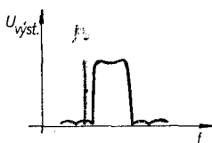
Obr. 42. Čtyřkrystalový filtr a jeho kmitočtová charakteristika
